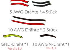
② Verwenden Sie den Seitenschneider, um 15 mm Isolierung von der Seite des Drahtes wie unten beschrieben abzuschneiden.
